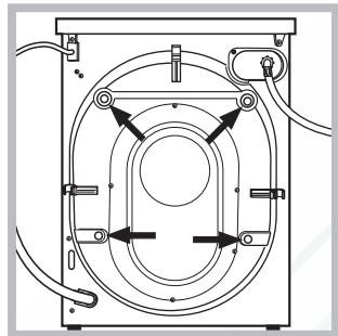
3. Снимите 4 винта, предохраняющие машину в процессе перевозки, и распорки, расположенные в задней части машины (см. схему).
